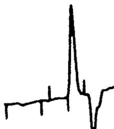
Abb. 5.1.2: Analyse von Wasserstoff mit Helium als Trägergas
