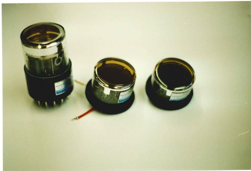
Abb. A.5: 8-stufiger Photomultiplier, Tetrode und Triode von HAMAMATSU.
