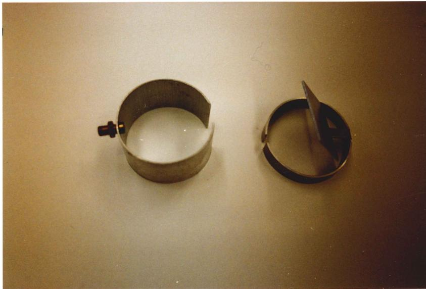
Abb. 3.9: Photomultiplieraufsätze zur diffusen Reflektion des Lichts. Der linke Aufsatz wurde gleichfalls zur diffusen Lichteinstrahlung für die Bestimmung der Veränderung von Verstärkung und Pulshöhenauflösung bei den 8-stufigen Photomultipliern verwendet.
