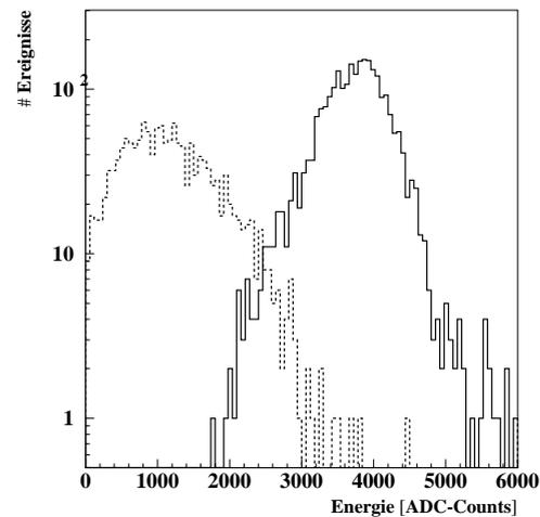
Abbildung 6.10: Verteilung der durch den Schnitt zur Entfernung der Untergründereignisse eliminierten (gestrichelt) und akzeptierten (durchgezogen) Ereignisse bei einer Nominalenergie von 4 (a) und 5 GeV (b).
