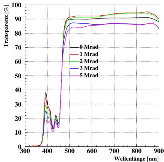
Abbildung 4.10: (a) Die Transparenz des Szintillators BC-408 als Funktion der Wellenlänge mit der applizierten Strahlendosis als Parameter. Die Zahlen bei den Kurven geben die Strahlendosis in Mrad an. (b) Die Transparenz des Wellenlängenschiebers BC-482A als Funktion der Wellenlänge mit der applizierten Strahlendosis als Parameter [19].
