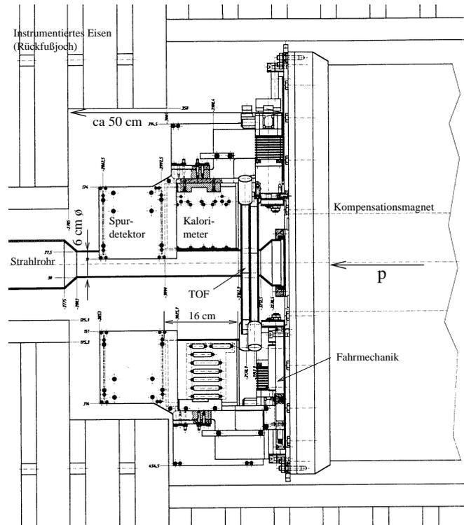
Abbildung 2.4: Der Einbaubereich des VLQ vergrößert dargestellt. Rechts ist der zylinderförmige Kompensationsmagnet zu sehen, an dem das ganze Spektrometer befestigt ist.
