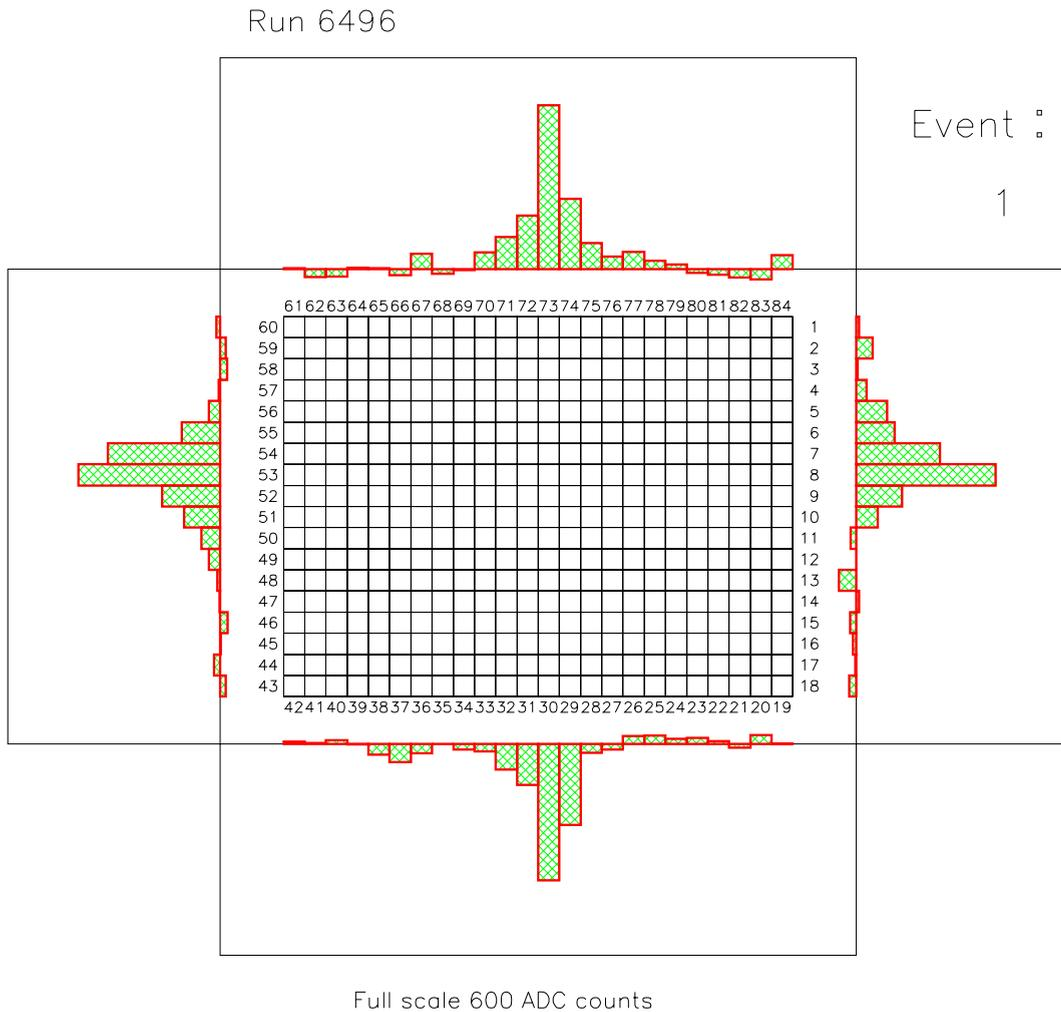
Abbildung 2.9: Eventdisplay eines mit der oben beschriebenen Struktur gemessenen Elektrons mit 5 GeV Energie (DESY Teststrahl).
