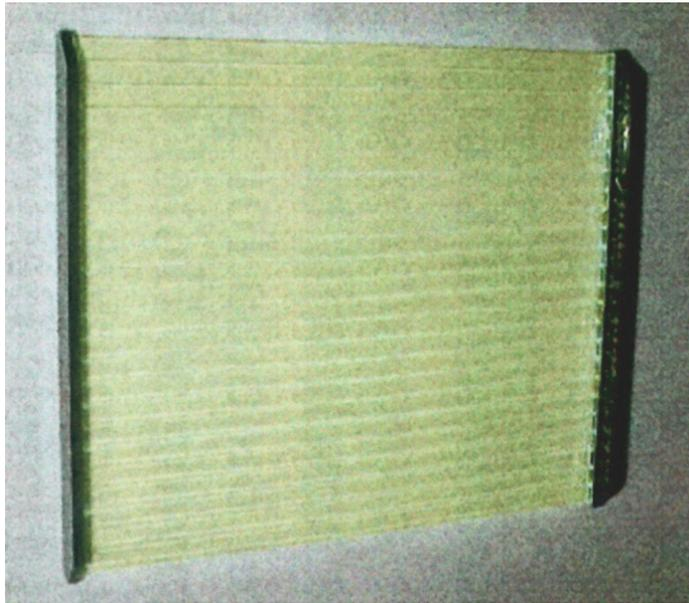
Abbildung 5.9: Eine Fotografie eines fertiggestellten Wellenlängenschieber-Photodioden-Arrays mit 24 Kanälen.
