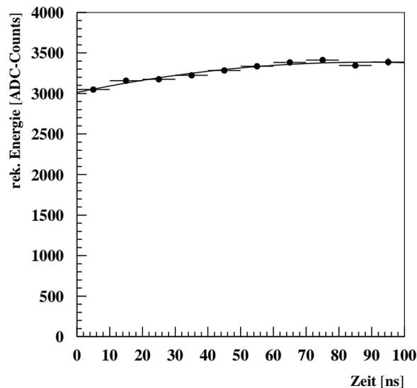
Abbildung 6.15: Die rekonstruierte Energie als Funktion des Auslesezeitpunktes. Das Maximum des Kalorimeterausgangssignales liegt im Abtastzeitraum.
