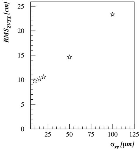
Abbildung 2.13: Die aus der Simulation bestimmte z-Vertex Auflösung als Funktion der Ortsauflösung der Spurdetektoren [7].
