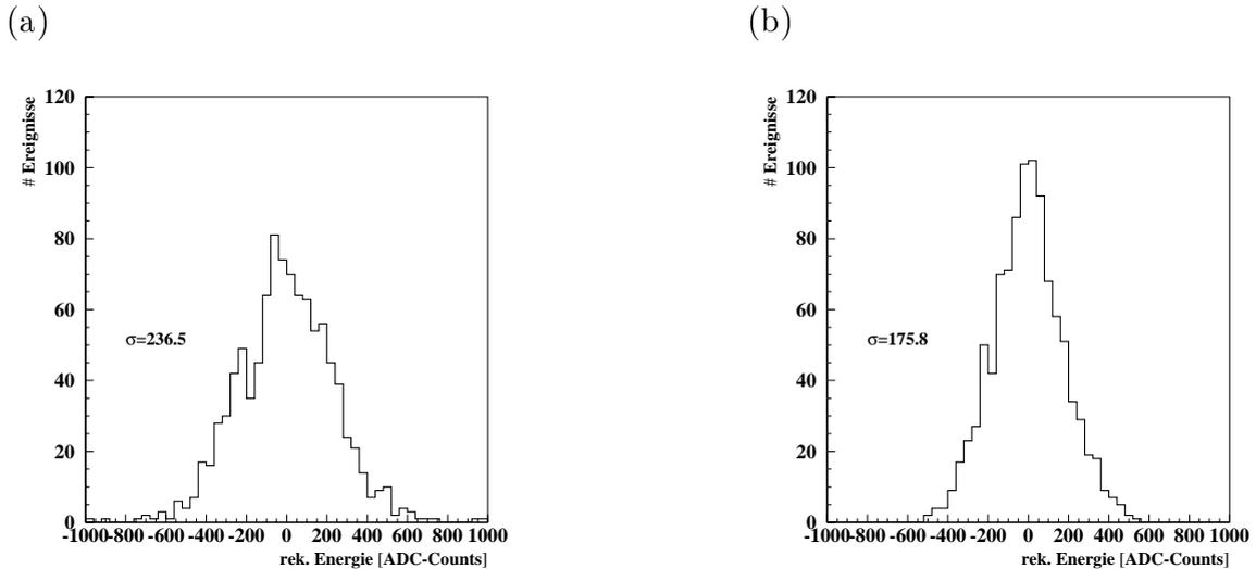
Abbildung 6.14: (a) Die Verteilung, die sich ergibt, wenn die Energierekonstruktion auf einen Pedestralrun angewendet wird und der kohärente Rauschanteil nicht abgezogen wird. (b) Die gleiche Verteilung wie in (a) mit abgezogenem kohärentem Rauschanteil.
