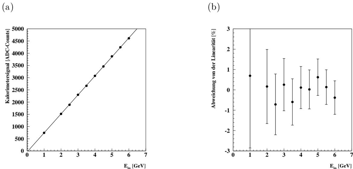
Abbildung 6.18: (a) Aus der Energierekonstruktion bestimmter Mittelwert aufgetragen gegen die Einschußenergie. (b) Die Abweichung der Meßpunkte von einem idealen linearen Verhalten. Die Größe der Fehler ist im wesentlichen durch den systematischen Fehler gegeben, der durch die Untergrundereignisse des Teststrahles verursacht wird.
