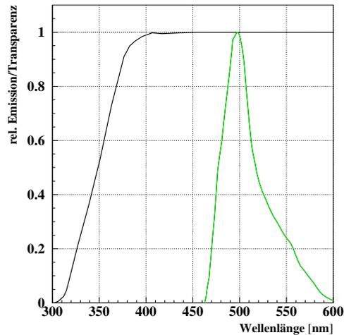
Abbildung 4.6: Die Transparenz einer  $25.4 \mu\text{m}$  dicken Schicht des Klebers 302-3M als Funktion der Wellenlänge. Ebenfalls eingezeichnet ist das Emissionsspektrum der Wellenlängenschieber. Im gesamten Bereich der Emission der Wellenlängenschieber ist die Transparenz größer als 99%.
