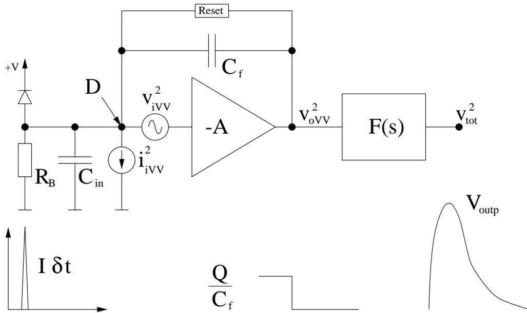
Abbildung 4.16: Prinzipschaltbild eines Ladungsverstärkers. Das Dreieck repräsentiert einen idealen invertierenden Spannungsverstärker mit der Verstärkung  $A$ . Das Rauschen jedes realen Verstärkers kann mit einer Rauschspannungsquelle und einer Rauschstromquelle am Eingang beschrieben werden.
