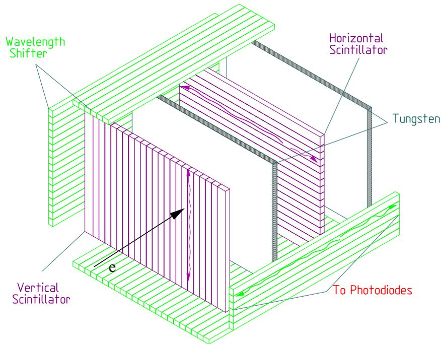
Abbildung 2.8: Vereinfachte Explosionsansicht der Kalorimeterstruktur. Als Absorbermaterial ist Wolfram verwendet. Der aktive Teil des Kalorimeters besteht aus Plastikszintillatorstreifen, die abwechselnd horizontal und vertikal ausgerichtet sind. Das Licht aus den Plastikszintillatoren wird von den seitlich angeordneten Wellenlängenschiebern absorbiert und zu deren Stirnflächen geleitet, wo es von Photodioden nachgewiesen wird.
