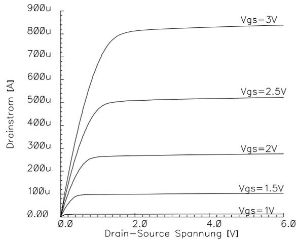
Abbildung 4.12: Das Ausgangskennlinienfeld eines nMOS-Transistors. Der Drainstrom  $I_D$  steigt bis zu einem Sättigungswert an. Nach Erreichen der Sättigung steigt der Drainstrom nur noch schwach aufgrund der Kanallängenmodulation an.
