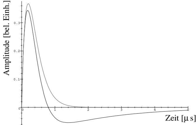
Abbildung 4.17: Das Ausgangssignal des Shapers ( $n=1$ ,  $A=10$ ) bei einer idealen Sprungfunktion als Eingang und bei einer langsam abfallenden Sprungfunktion als Eingang.
