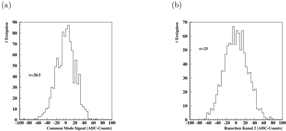
Abbildung 6.13: (a) Die Verteilung des kohärenten Rauschanteils für den rechten vertikalen Wellenlängenschieberarray. (b) Die gleiche Rauschverteilung wie in Abbildung 6.12(b) mit abgezogenem kohärentem Anteil.
