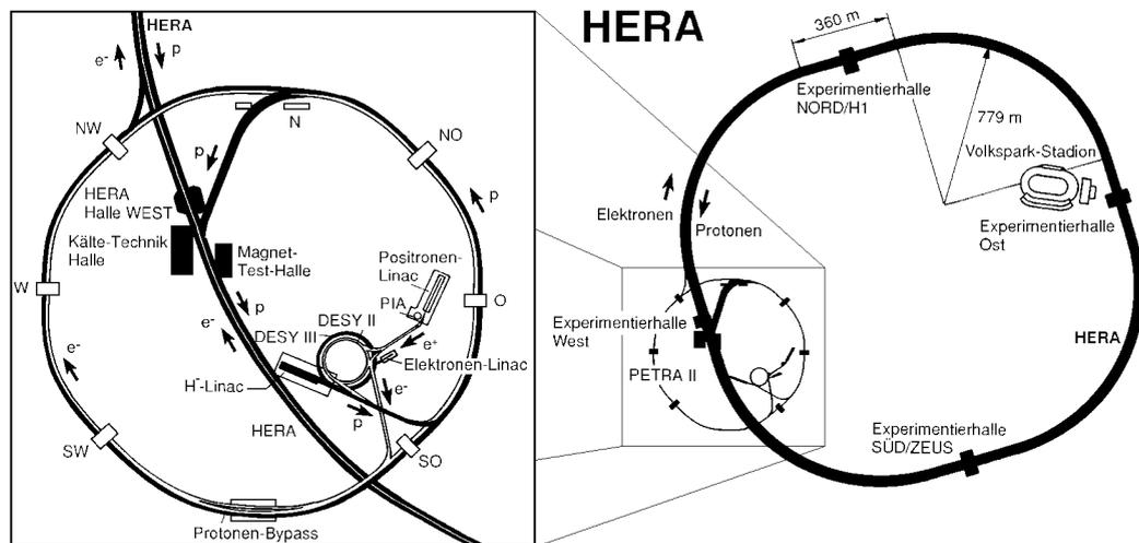
Abbildung 0.1: Der Speicherring HERA im Überblick. HERA wird durch verschiedene Vorbeschleuniger, die ebenfalls zu erkennen sind, mit Elektronen und Protonen gespeist.
