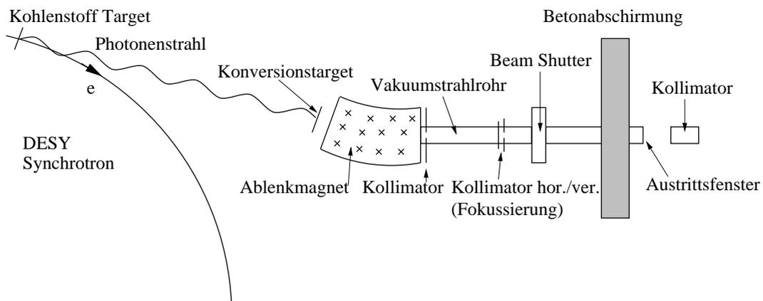
Abbildung 6.1: Die Erzeugung des Elektronenteststrahles am DESY-Synchrotron.
