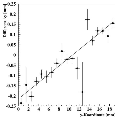
Abbildung 6.25: Die Korrelation der Differenz der Ortsmessung zweier in x-Richtung orientierter Detektoren mit der Ortsmessung selbst. Aus der Steigung der angepaßten Geraden kann der Verdrehungswinkel  $\beta$  bestimmt werden. Die Fehlerbalken sind durch den statistischen Fehler bestimmt.
