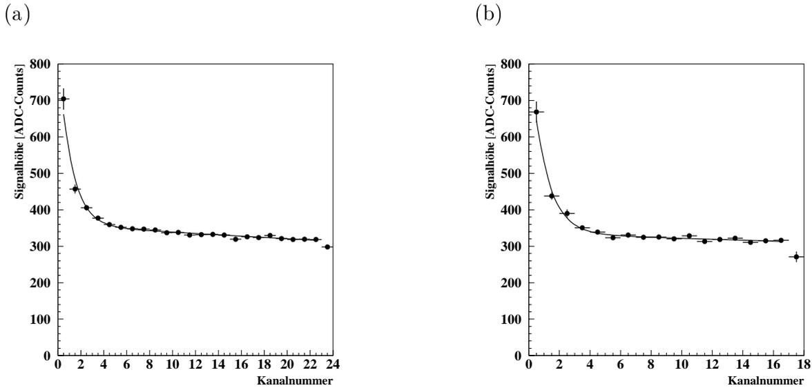
Abbildung 6.17: (a) Das Ausgangssignal der horizontalen Kanäle in Abhängigkeit der Kanalnummer des vertikalen Kanals, in dem das Elektron aufgetroffen ist. (b) Das Ausgangssignal der vertikalen Kanäle in Abhängigkeit der Kanalnummer des horizontalen Kanals, in dem das Elektron aufgetroffen ist.
