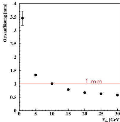
Abbildung 3.8: Die Ortsauflösung aus der Schauersimulation als Funktion der Einschußenergie.
