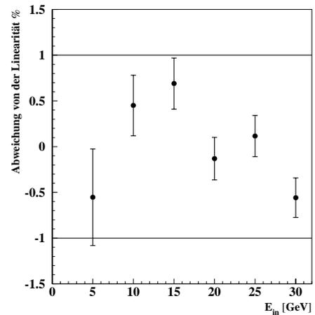
Abbildung 3.6: (a) Die im Szintillator deponierte Energie gegen die Einschußenergie aufgetragen. (b) Die Abweichung vom idealen linearen Verhalten in Prozent als Funktion der Einschußenergie. Alle Daten sind aus der Simulation gewonnen.
