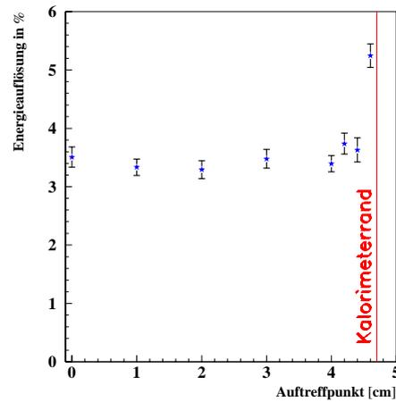
Abbildung 3.9: (a) Die auf zentralen Einschuß normierte, im Kalorimeter deponierte Energie als Funktion des Auftreffpunktes. (b) Die Energieauflösung als Funktion des Auftreffpunktes. Alle Daten sind aus der Schauersimulation gewonnen.
