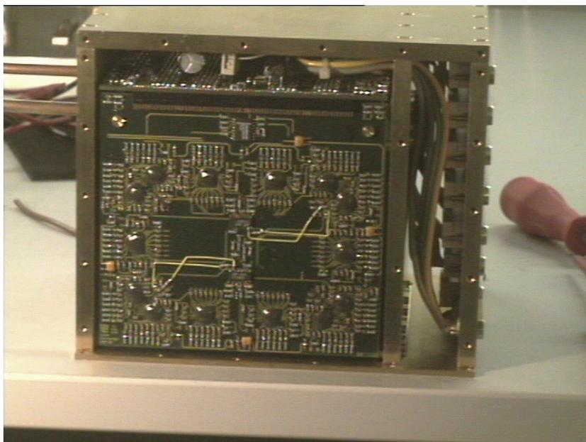
Abbildung 5.14: Das geöffnete Kalorimeter mit komplett montierter Elektronik.
