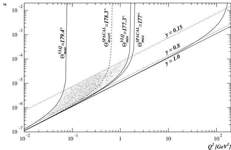
Abbildung 2.10: Akzeptanzbereich des VLQ in der  $x - Q^2$  Ebene. Die eingezeichneten Linien bedeuten Linien gleichen Ablenkwinkels. Es ist deutlich zu sehen, daß zwischen dem Spacal und VLQ Detektor ein Überlapp vorhanden ist. Die diagonalen gepunkteten Linien sind Linien mit konstantem  $y$ .
