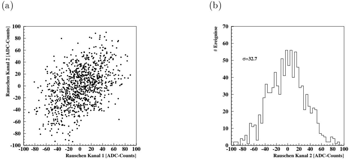
Abbildung 6.12: (a) Die Korrelation im Rauschen der beiden benachbarten Kanäle 1 und 2. Es ist deutlich zu erkennen, daß eine leichte Korrelation besteht. (b) Das Rauschspektrum des Kanals 2.
