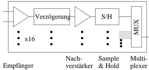
Abbildung 4.31: Die Funktion einer Analogkarte in einem Blockschaltbild dargestellt. Die Kalorimetersignale werden von einem Empfänger aufgenommen und mit einer LC-Kette  $2.2 \mu\text{s}$  verzögert. Nach der Verzögerung werden die Signale nachverstärkt und mit einem Sample-and-Hold-Schaltkreis analog gespeichert. Die gespeicherten Signale werden bei Bedarf über einen Multiplexer ausgegeben.
