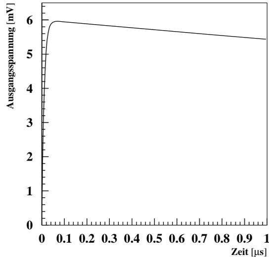
Abbildung 4.21: Das durch einen deltaförmigen Strompuls am Eingang des Vorverstärkers erzeugte Ausgangssignal. Das Signal steigt schnell an und fällt dann langsam durch die Entladung des Rückkoppelkondensators über den Rückkoppelwiderstand wieder ab. Die Anstiegsgeschwindigkeit ist durch die Bandbreite des Vorverstärkers begrenzt.
