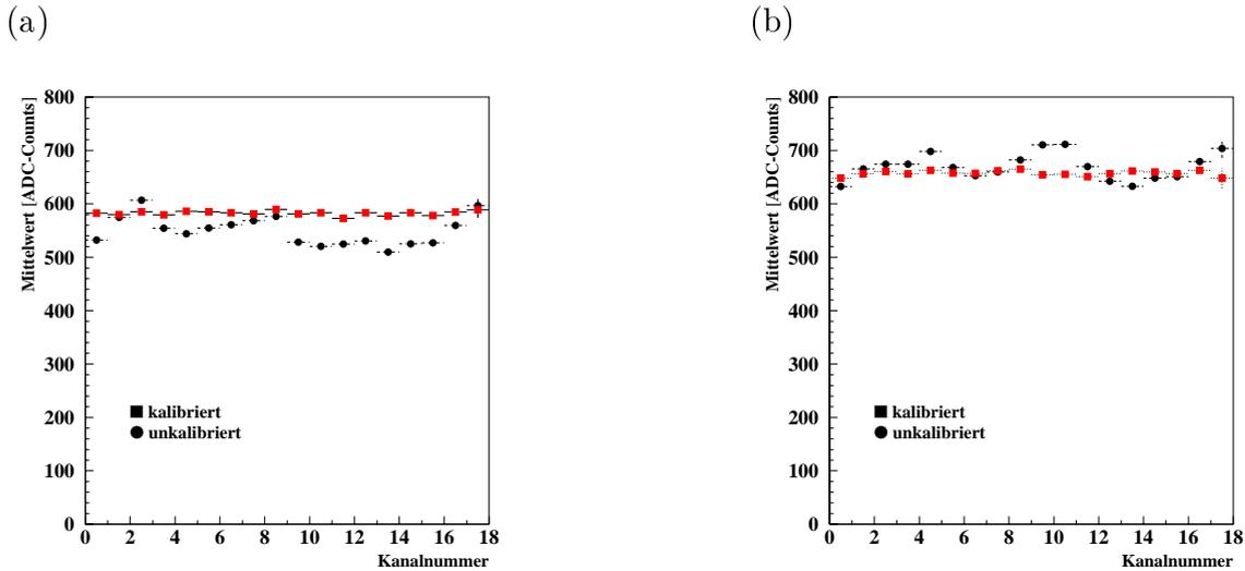
Abbildung 6.8: Verteilung der Mittelwerte der Summe aus dem maximalen und seinen beiden Nachbarkanälen über die Kanalnummern aufgetragen. Die runden Punkte ergeben sich, wenn die Kalibrationskonstanten nicht angewendet werden. Die quadratischen Punkte werden nach Anwendung der Kalibrationskonstanten erhalten. Es sind der linke (a) und rechte (b) vertikale Wellenlängenschieberarray aufgetragen.
