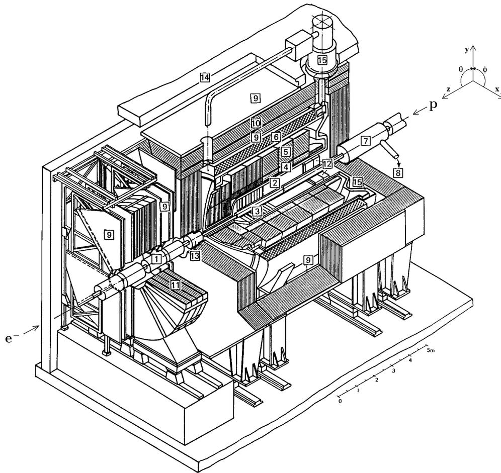
Abbildung 1.1: Der H1-Detektor im Querschnitt.
