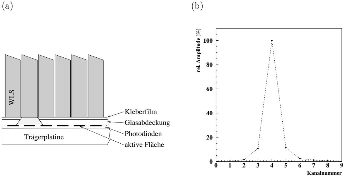
Abbildung 4.7: (a) Die Klebestelle der Wellenlängenschieberstreifen (WLS) auf die Photodioden schematisch dargestellt. Durch den Austrittstrichter des Lichtes aus den Wellenlängenschiebern kommt es zum Übersprechen auf Nachbarkanäle. (b) Übersprechen zwischen den Auslesekanälen. Die Meßwerte sind auf die Amplitude des Kanals(4) normiert, in den das Licht eingekoppelt wird [16].
