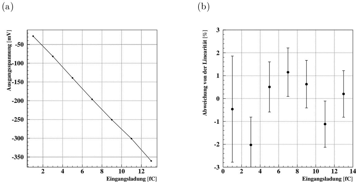
Abbildung 4.28: (a) Die Ausgangsspannung des Triggerkanals in Abhängigkeit der eingekoppelten Ladung. (b) Die Abweichung der Meßpunkte aus (a) vom idealen linearen Verhalten [21].
