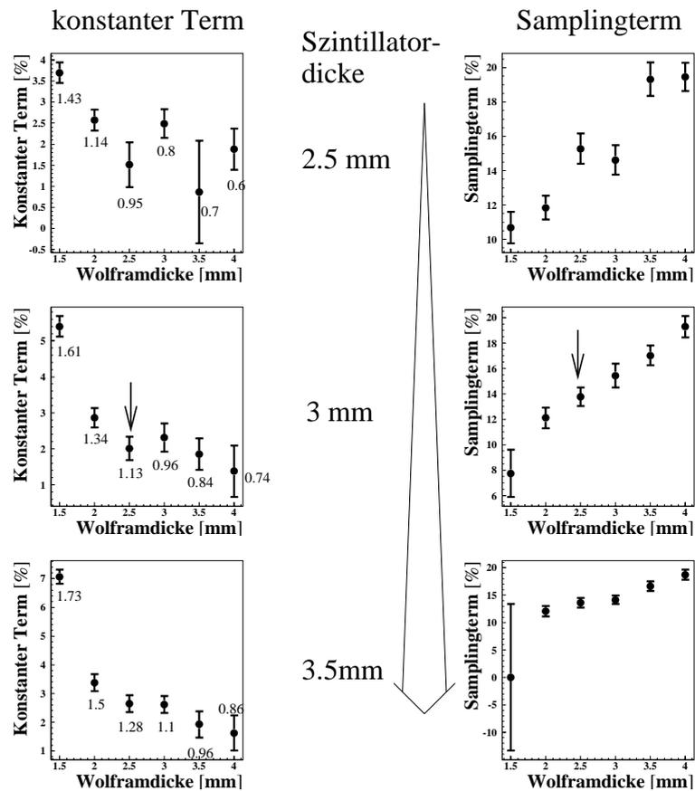
Abbildung 3.2: Ergebnis der Optimierung des Dickenverhältnisses von Szintillator und Wolfram. Links ist der konstante Term aufgetragen, rechts der Samplingterm. Von oben nach unten steigt die Dicke des Szintillators. Von links nach rechts steigt die Dicke des Wolfram.
