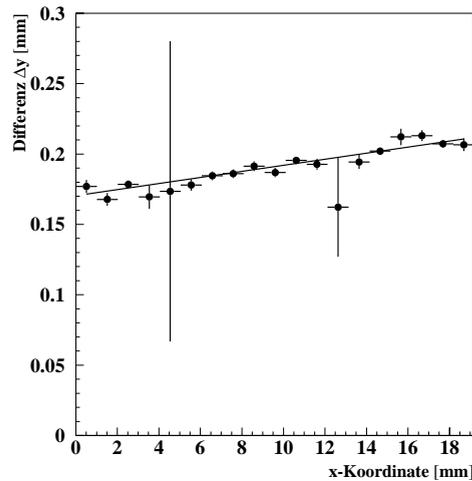
Abbildung 6.24: Der Zusammenhang der Differenz der Ortsbestimmung  $\Delta y$  zweier in x-Richtung orientierter Detektoren mit der x-Koordinate. Der Achsenabschnitt der angepaßten Gerade gibt die Verschiebung  $x_o$  und die Steigung den Verkippungswinkel  $\alpha$  an. Die Fehlerbalken sind durch die Statistik bestimmt.
