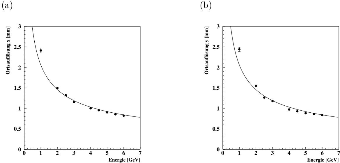
Abbildung 6.32: Die Ortsauflösung des VLQ-Kalorimeters als Funktion der Einschußenergie der Elektronen für die x- (a) und y-Koordinate (b). Bei dem Run mit 3.5 GeV sind die Si-Teleskop Daten fehlerhaft. Deshalb ist dieser Meßpunkt weggelassen. Die Größe der Fehler entspricht der Ausdehnung der eingezeichneten Meßpunkte.
