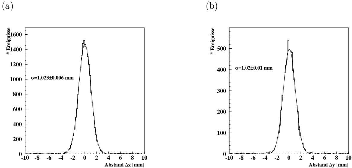
Abbildung 6.31: Der Abstand zwischen dem aus dem Kalorimeter rekonstruierten und aus den Si-Teleskop Daten extrapolierten Auftreffpunkt in x- (a) und y-Richtung. Die Breite der Verteilungen gibt die Ortsauflösung an und beträgt 1 mm.
