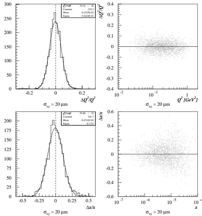
Abbildung 2.11: Differenz zwischen den generierten und rekonstruierten kinematischen Variablen  $x$  und  $Q^2$ . Die Auflösung in  $Q^2$  beträgt 4.4 %. Die Auflösung in  $x$  beträgt 11.5 %. Beide Auflösungen sind über den gesamten Akzeptanzbereich fast konstant.[7]
