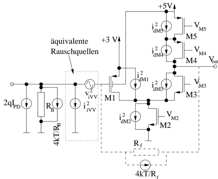
Abbildung 4.22: Das Schaltbild des Vorverstärkers mit allen Rauschquellen.
