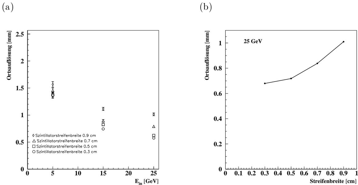
Abbildung 3.4: (a) Ergebnis der Optimierung der Streifenbreite. Aufgetragen ist die Ortsauflösung als Funktion der Energie für verschiedene Streifenbreiten. (b) Die Ortsauflösung als Funktion der Streifenbreite bei einer Einschußenergie von 25 GeV.
