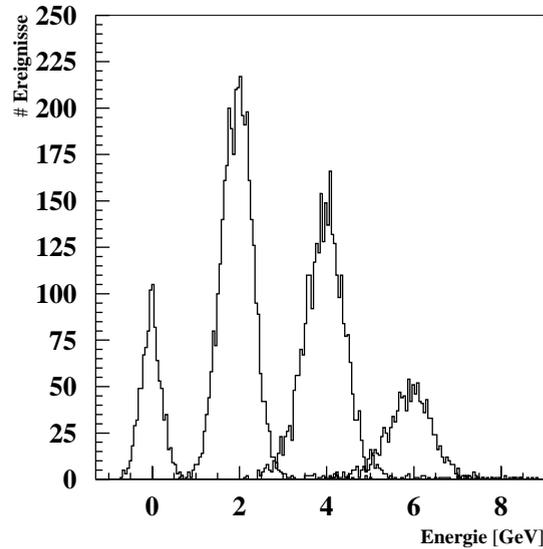
Abbildung 6.19: Die mit dem VLQ-Kalorimeter gemessenen Energieverteilungen von Elektronen mit 2, 4 und 6 GeV Energie. Die Verteilung bei Null GeV entspricht einem Pedestalrun.
