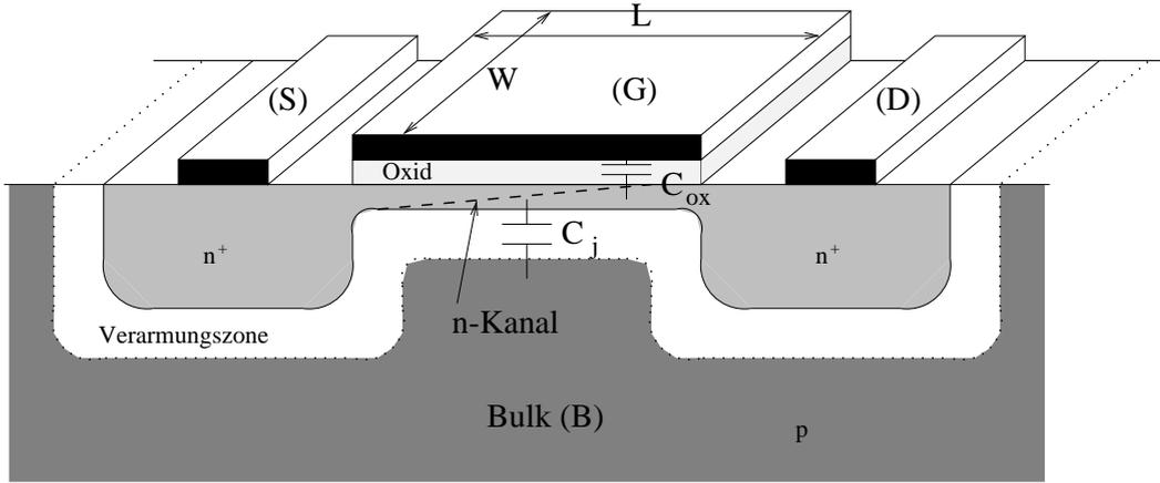
Abbildung 4.11: Ein nMOS-Transistor im Querschnitt, das Gate (G) des Transistors ist durch eine Isolatorschicht vom Substrat (B) getrennt. Source (S) und Drain (D) sind durch den leitenden n-Kanal verbunden, dessen Leitfähigkeit mit der Gatespannung kontrolliert werden kann.
