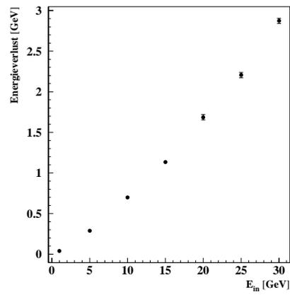
Abbildung 3.11: Aus der Schauersimulation bestimmte, nicht im Kalorimeter absorbierte Schauerenergie als Funktion der Einschüßenergie der Elektronen.
