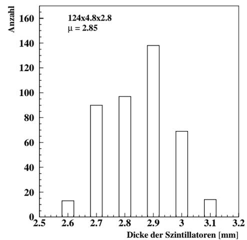
Abbildung 5.5: Die Dickeverteilung der Szintillatoren mit den verschiedenen Maßen.
