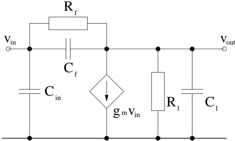
Abbildung 4.20: Das vereinfachte Kleinsignalersatzschaltbild des Vorverstärkers aus Abbildung 4.19.
