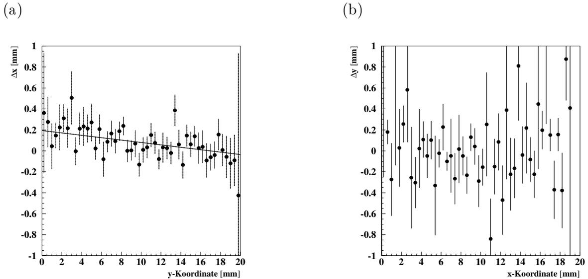
Abbildung 6.30: Der Abstand zwischen extrapoliertem und gemessenem Auftreffpunkt über der jeweils anderen Koordinate aufgetragen für die x- (a) und y-Richtung (b). Die Fehlerbalken sind die statistischen Fehler.
