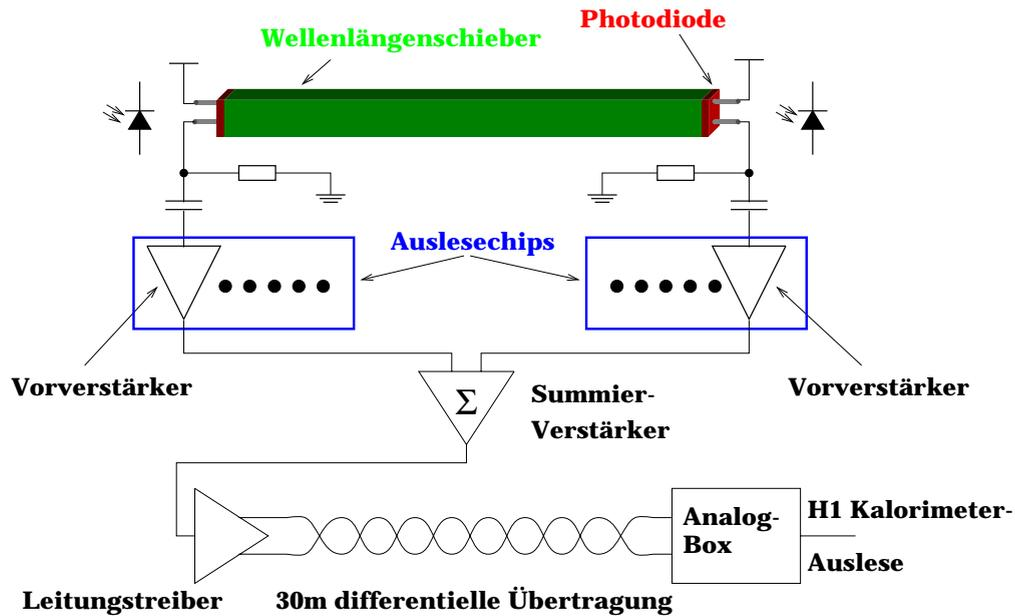
Abbildung 4.29: Die Auslekeselette des VLQ-Kalorimeters für einen Kanal. Jeder Wellenlängenschieber wird an beiden Enden von je einer Photodiode ausgelesen. Das Photodiodesignal wird durch die Ladungsverstärker auf den Auslekesehips verstärkt und anschließend die Signale von beiden Enden summiert. Das Summensignal wird dann über einen Leitungstreiber differentiell über ca. 30 m Kabel zur Analog-Box transportiert.
