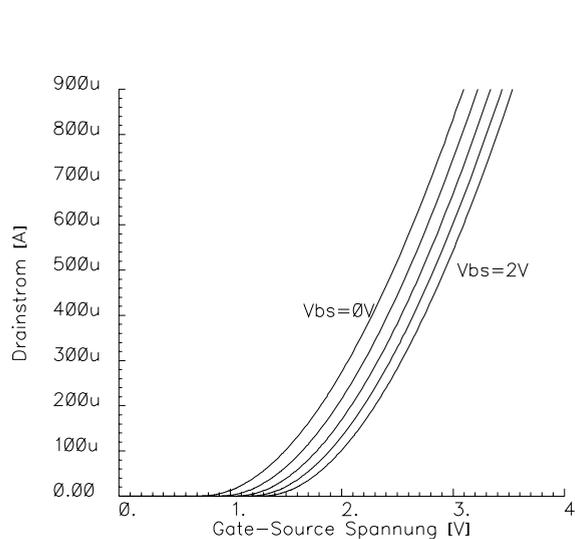
Abbildung 4.13: Die Übertragungskennlinie eines nMOS Transistors für verschiedene  $V_{BS}$  von 0 bis 2 V in Schritten von 0.5 V.
