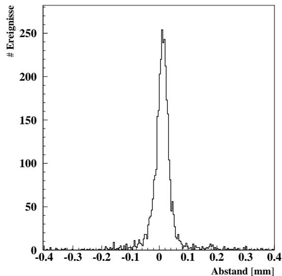
Abbildung 6.26: Der Abstand zwischen der Messung der Elektronenkoordinate mit der letzten Streifendetektorlage für die x-Richtung im Si-Teleskop und der aus den anderen Detektorlagen bestimmten Elektronspur. Der Mittelwert der Verteilung liegt erwartungsgemäß bei Null, die mittlere quadratische Abweichung beträgt 0.02 mm.
