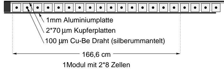
Abb. 3.8.: Aufbau eines LST Profils im Eisen
