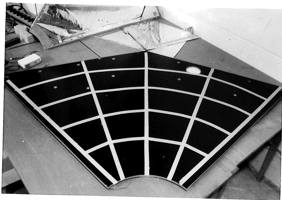
Abbildung 5.10: Koordinatenmuster für Testmessungen des Widerstandes der hochohmigen Schicht.
