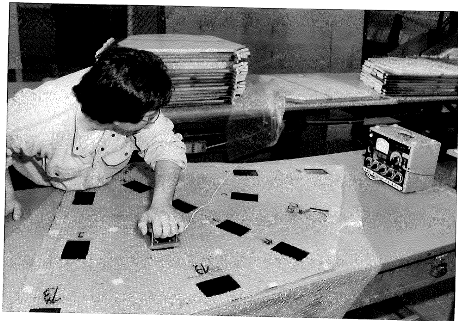
Abbildung 5.9: Nach dem "Backen" wird der Widerstand der hochohmigen Schicht an einigen Punkten gemessen.
