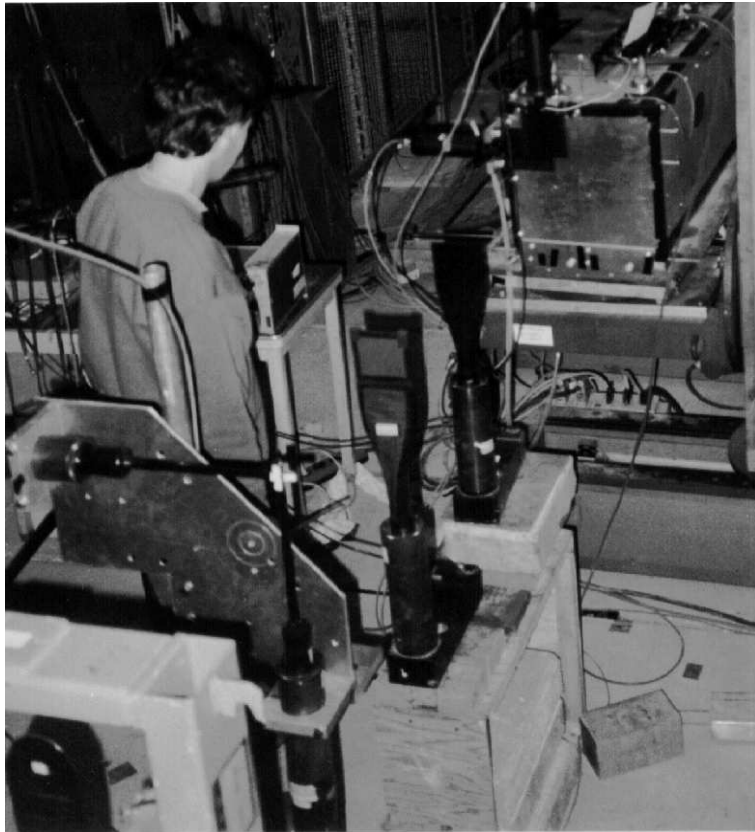
Abbildung 4.4: Dieses Photo zeigt einen Ausschnitt des Testaufbaus am CERN-SPS X5A, der schon in Abbildung 4.3 erklärt wurde. Links unten ist ein Stück schwarz umwickeltes Szintillatormaterial zu sehen. Es ist Teil des Lochzählers V, der in Gleichung 4.11 in Antikoinzidenz geschaltet ist. Das Loch befindet sich an der weiß beklebten Stelle. Folgt man der Bilddiagonalen von links unten nach rechts oben, so erkennt man den horizontalen FH und den vertikalen Fingerzähler FV, die sich in einer Fläche von 1 \times 1 \text{ cm}^2 überlappen. Folgt man der durch diese drei Triggerzähler definierten Strahlrichtung, so findet man in der rechten oberen Ecke einen Kasten mit der Größe 32 \times 32 \times 65 \text{ cm}^3 . In diesem 1 cm dicken Al-Gehäuse mit einem dünnen Frontfenster befindet sich das SpaCal-Modul (siehe Abbildung 4.6 oben). Es steht auf dem Winkeltisch, der nicht nur die Wahl verschiedener Einschufwinkeln, sondern auch verschiedener Einschufpositionen ermöglicht hat.
