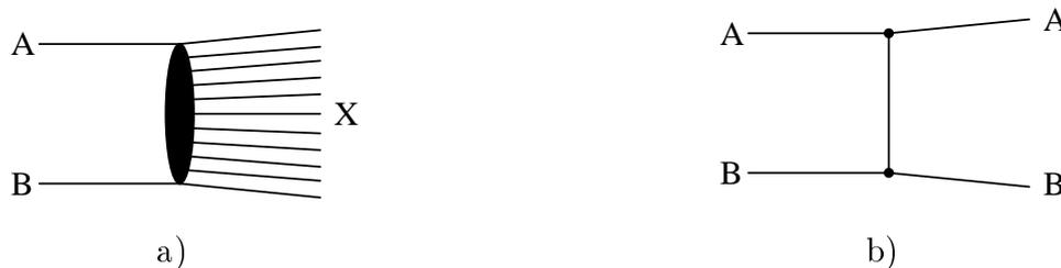
FIG. 1.1 – Représentations schématiques a) de la réaction inélastique  $AB \rightarrow X$  ; b) de la réaction élastique  $AB \rightarrow AB$ .
