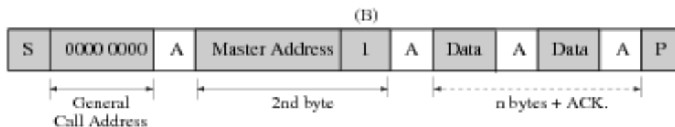
Abbildung 5.11: Übertragungssequenz eines Hardware-General Call [I 2 C98].
