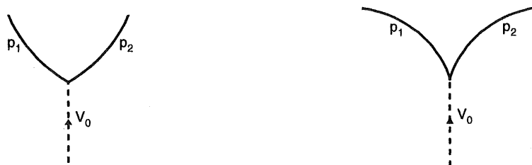
Abbildung 6.3: Die beiden möglichen Topologien am Zerfallsort eines K_s^0 -Mesons. Die Konstellation in der linken Abbildung wird als „Cowboy“, die in der rechten Abbildung als „Seemann“ bezeichnet.
